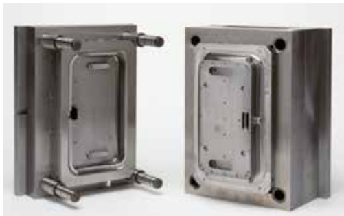
Plastformningsverktyg av verktygstål som används vid tillverkning av mobiltelefoner.
